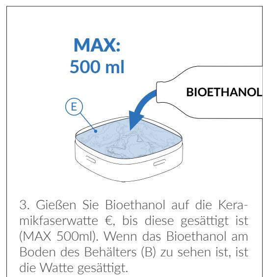
3. Gießen Sie Bioethanol auf die Keramikfaserwatte €, bis diese gesättigt ist (MAX 500ml). Wenn das Bioethanol am Boden des Behälters (B) zu sehen ist, ist die Watte gesättigt.
