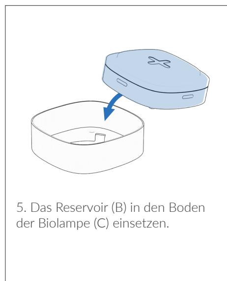
5. Das Reservoir (B) in den Boden der Biolampe (C) einsetzen.
