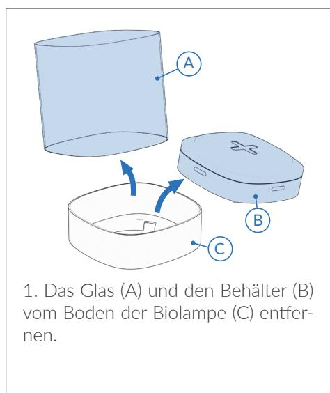
1. Das Glas (A) und den Behälter (B) vom Boden der Biolampe (C) entfernen.
