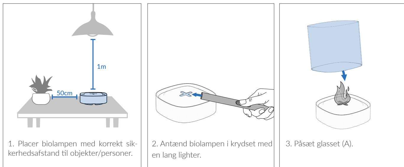
**BEMÆRK:** Undgå at holde hovedet ind over biolampen under antænding. Hold hår og løsthængende tøj væk fra biolampen når den antændes.
