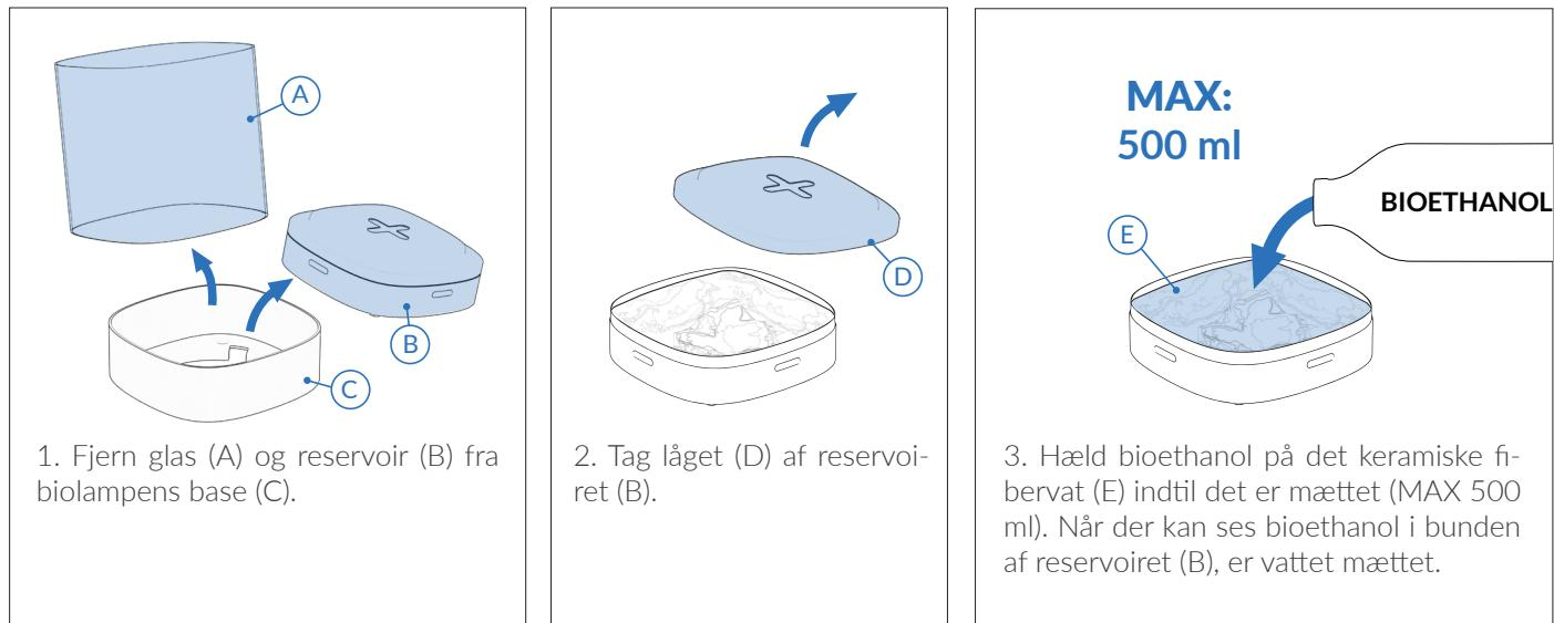
**BEMÆRK:** Overfyld aldrig reservoiret! Reservoiret må ikke fyldes til kanten med bioethanol. Når der er mere bioethanol i reservoiret end det keramiske fibervat kan absorbere, kan man nemt spilde bioethanol under håndtering af biolampen, og det kan brænde ukontrollabelt. Det keramiske fibervat skal blive i reservoiret og må kun fernes ved udskiftning.
